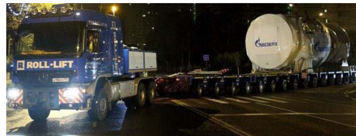
Рис. 12. Доставка новой газовой турбины энергоблока ПГУ-420 на ТЭЦ-20
