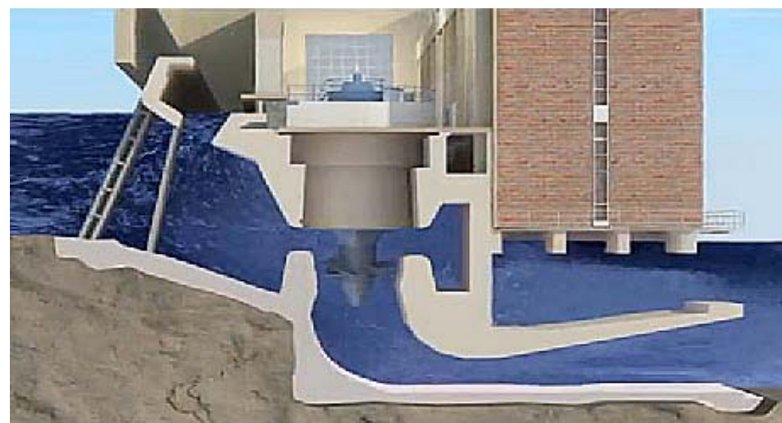
Рис. 40. Схема работы гидротурбины (на примере Лесогорской ГЭС)
